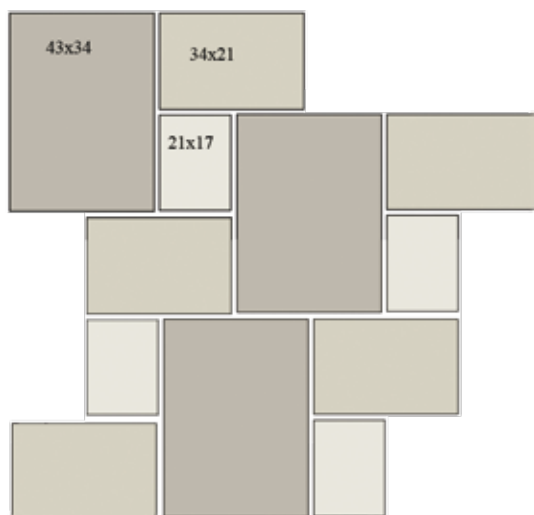
Verlegemuster für die Pflasterplatten der Gallo Serie
